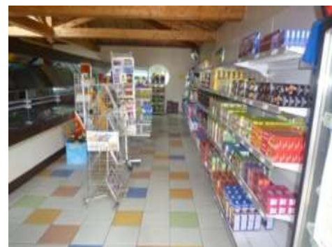
☹ La largeur du cheminement est conforme (1.40 m) mais du mobilier dans l'allée rend impossible le passage d'une personne en fauteuil roulant
