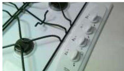
😊 Les repères tactiles sont réalisés avec de la résine. Un petit point indique une intensité faible ; un gros point une intensité plus forte
