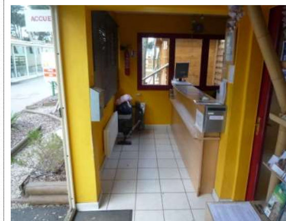
☹️ Sans aire de rotation, impossible de faire 1/2 tour une fois entré dans l'espace d'accueil. (A noter : le comptoir d'accueil ne propose pas de partie surbaissée)
