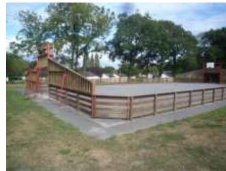
☹ Il manque un cheminement conforme pour rejoindre ce terrain « multi-activités »
